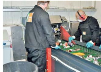
Ve vysočanském areálu Pražských služeb najdete moderní poloautomatickou linku na třídění kovových obalů, na níž se oddělují železné a neželezné kovy
