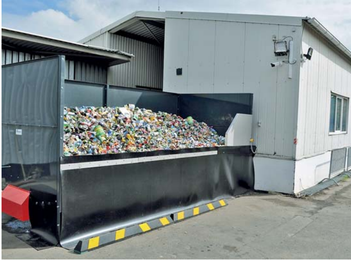
Ve vysočanském areálu Pražských služeb najdete moderní poloautomatickou linku na třídění kovových obalů, na níž se oddělují železné a neželezné kovy
