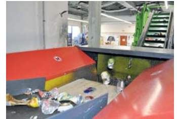
Ve vysočanském areálu Pražských služeb najdete moderní poloautomatickou linku na třídění kovových obalů, na níž se oddělují železné a neželezné kovy
