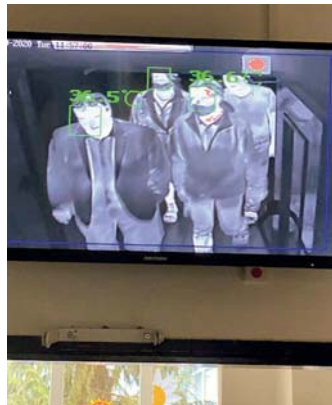
Ve dvou největších základních školách zřizovaných MČ Praha 9 byly u vchodů instalovány „chytré teploměry“ v podobě termokamer
