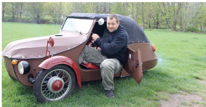
Jan Poupě a jeho Velorex 16/350 (mechanika), rok výroby 1967, hmotnost 310 kg, výkon 11 kW, zdvihový objem 344 cm 3 , maximální rychlost 85 km/hod.
