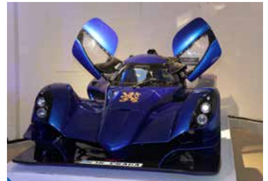
Novodobý silniční automobil Praga R1R vychází se závodních speciálů. Díky lehké a zároveň pevné uhlíkové konstrukci dosahuje lepších parametrů než klasické závodní vozy – hmotnost jen 670 kg, výkon 575 koní a ohromující zrychlení z 0 na 100 km/hod. pod tři vteřiny.
